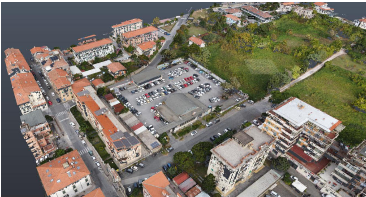
Figura 2.1-3 – Rilievo con nuvola di punti. Restituzione grafica eseguita con software “Autodesk Recap”.
