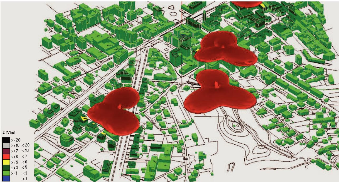
Fig. 192 Impatto elettromagnetico – Zona Via Stazione e Area Monte di Pasta – 0°/Nord
