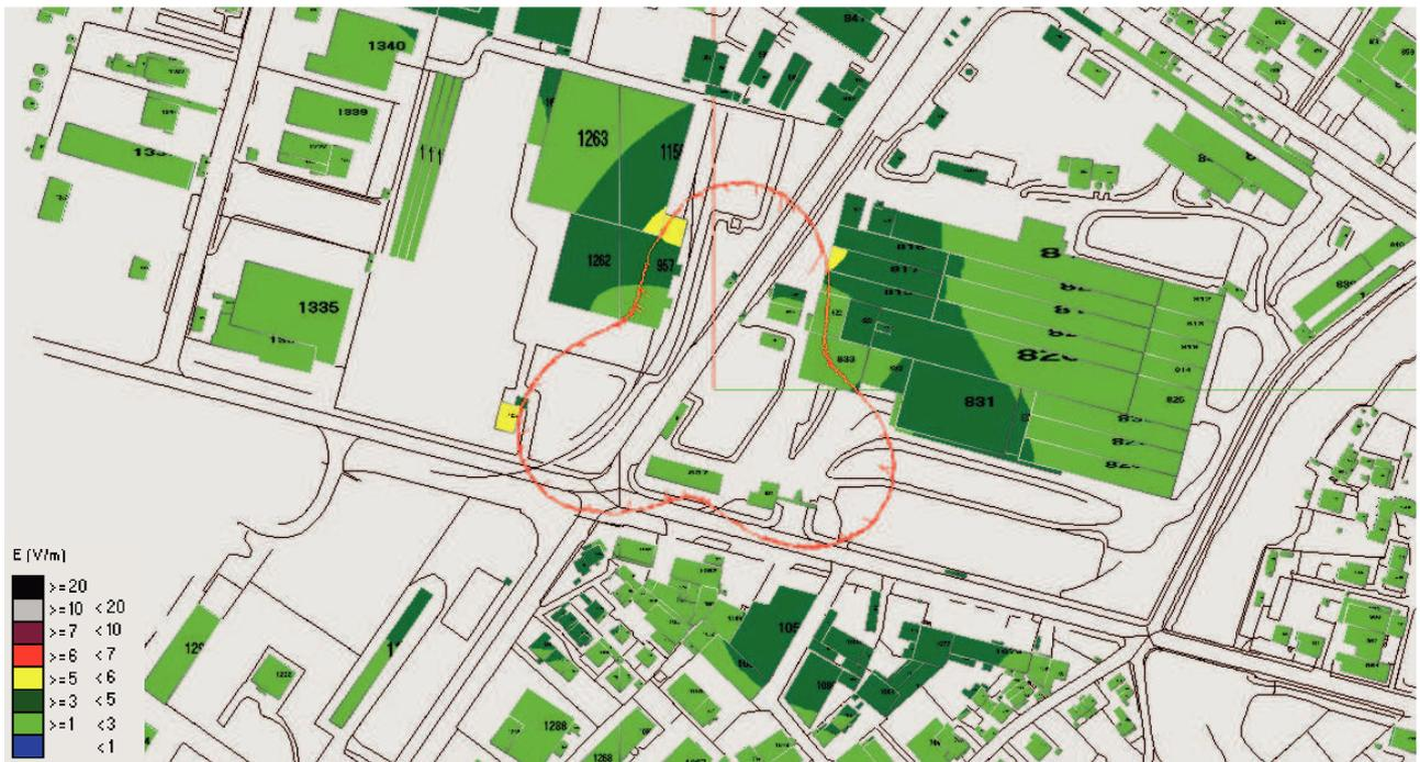
Fig. 208 Impatto elettromagnetico – Zona Via Catagnina – Vista dall'alto
