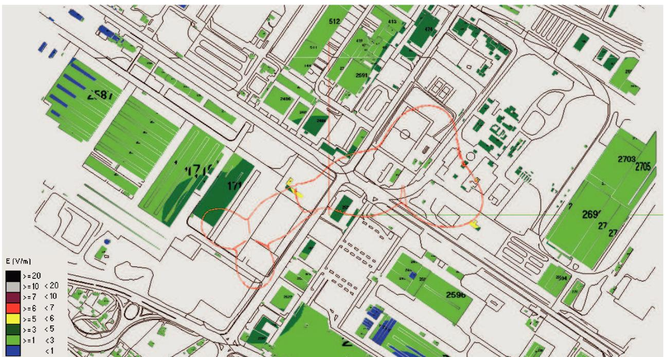
Fig. 63 Impatto elettromagnetico – Zona Via Dorsale e Area Parcheggio Via degli Oliveti – Vista dall'alto
